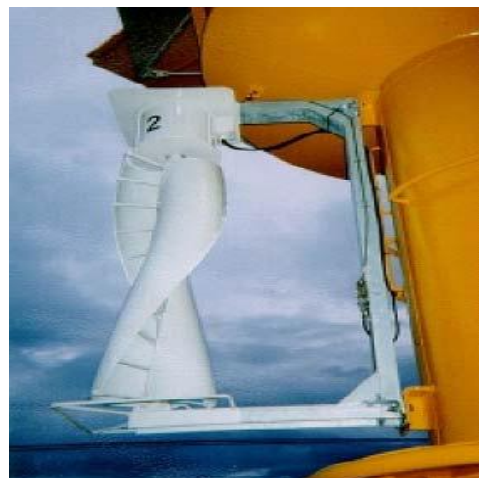
Figure I.15 : Aérogénérateur à axe vertical (structure de Savonius).
