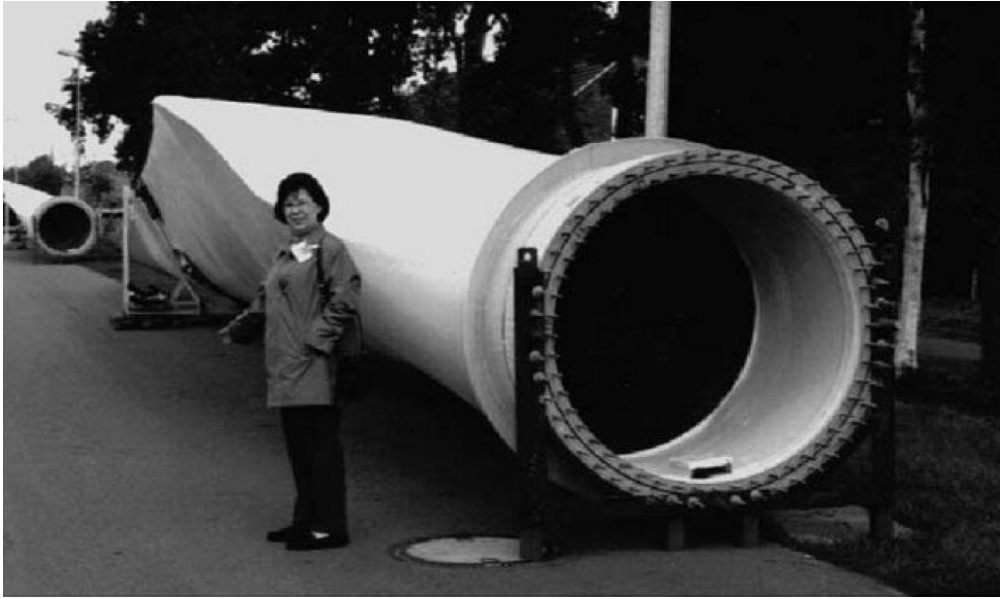
Figure I.21 : Pale d'une turbine éolienne de 1.5 MW.
