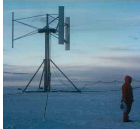
Figure I.14: Aérogénérateur à axe vertical (structure de Darrieus de type H).
