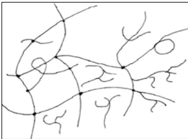
Figure A.I.3 : Représentation schématique d'un réseau covalent avec ses défauts.
