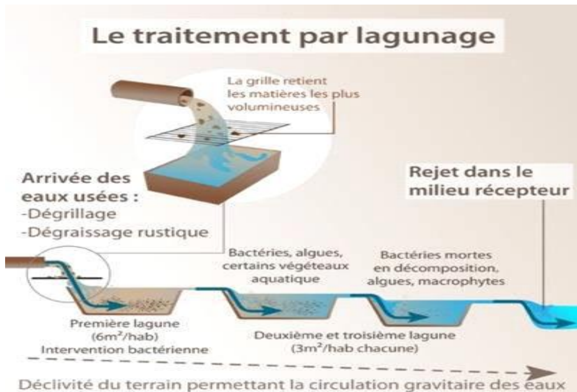
Figure 15 : Le principe d'épuration des eaux usées par lagunage naturelle(Site08 )
