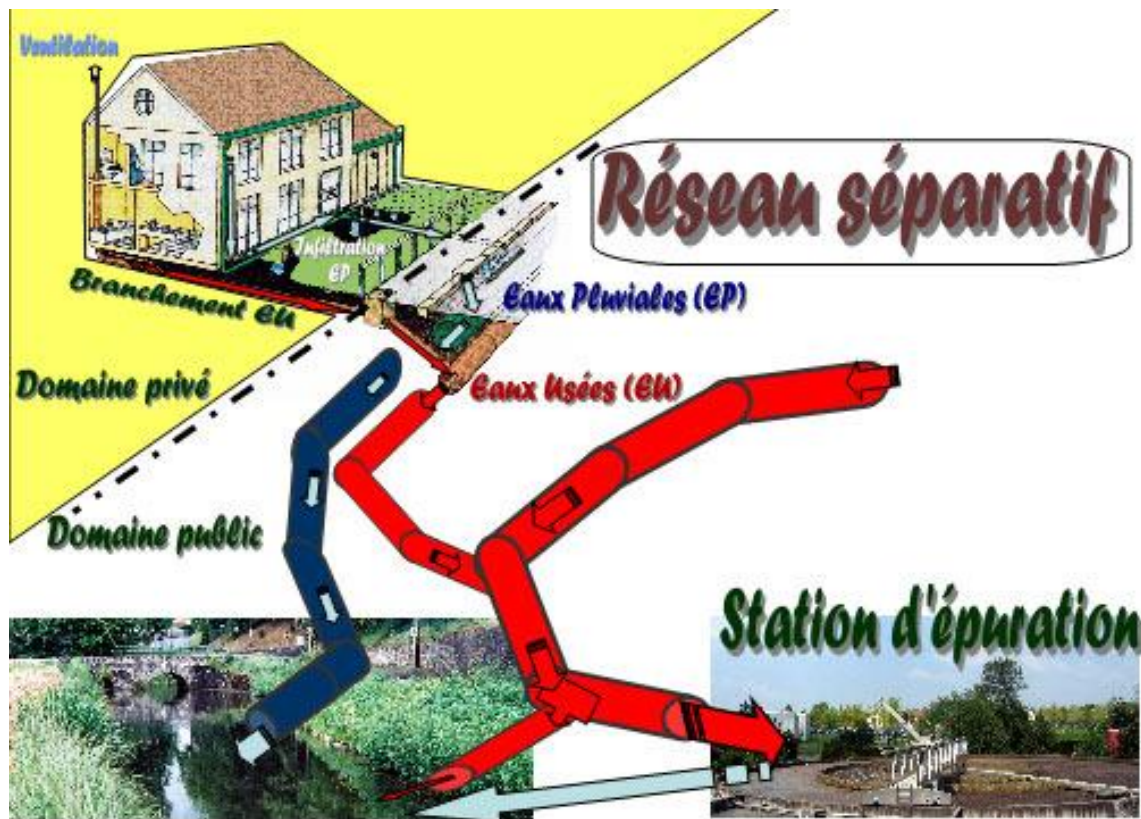
Figure09 : Réseau d'assainissement séparatif Source (Site 06 )
