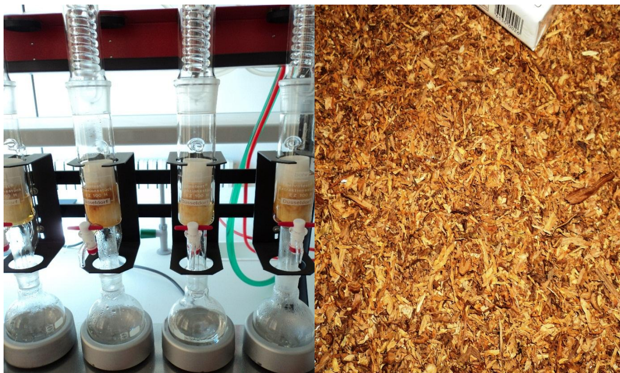
Figure 17: Préparation de l'extrait total du tabac par un système de Soxhlet multipostes.
