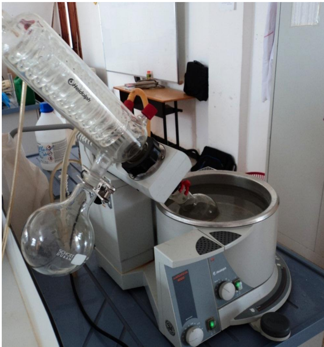
Figure 19 : Elimination des solvants par le rotavapor combiné à une pompe à vide.
