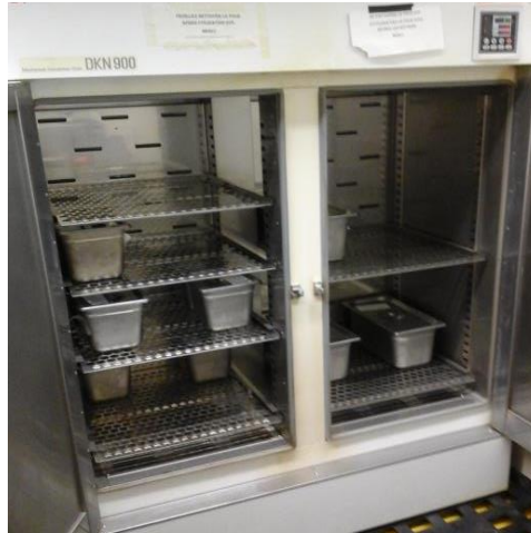
Figure 4. 1 Four à convection pour le test de vieillissement
