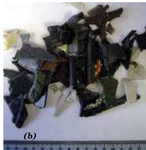
Figure 1.11. Résultat du broyage des carcasses de TV en plastique à l'aide d'un broyeur à cylindre denté modèle (Wagner 40) équipé d'un écran de 20 mm ;(a) : avant broyage ; (b) après broyage [61]
