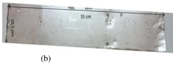
Figure 3.15. Photographie de deux électrodes. a) Electrode cylindrique ; b) Electrode à plaque.
