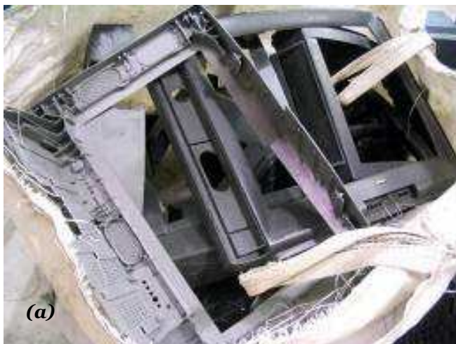
Figure 1.11. Résultat du broyage des carcasses de TV en plastique à l'aide d'un broyeur à cylindre denté modèle (Wagner 40) équipé d'un écran de 20 mm ;(a) : avant broyage ; (b) après broyage [61]
