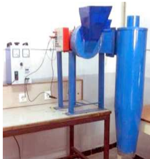
Figure 2.7. Représentation schématisée d'un dispositif de chargement par cyclone ; (a) principe de fonctionnement, (b) Photographie d'un dispositif de chargement par cyclone
