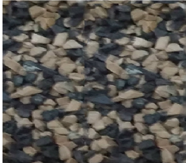
Figure 4.7. Echantillon des granules d'Acrylonitrile butadiène styrène ABS (marron et noir).
