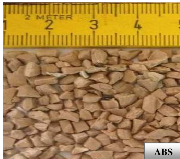
Figure 3.8. Echantillon des granules d'Acrylonitrile butadiène styrène (ABS) utilisées
