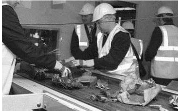
Figure 1.5. Traitement manuelle des DEEE. [56]
