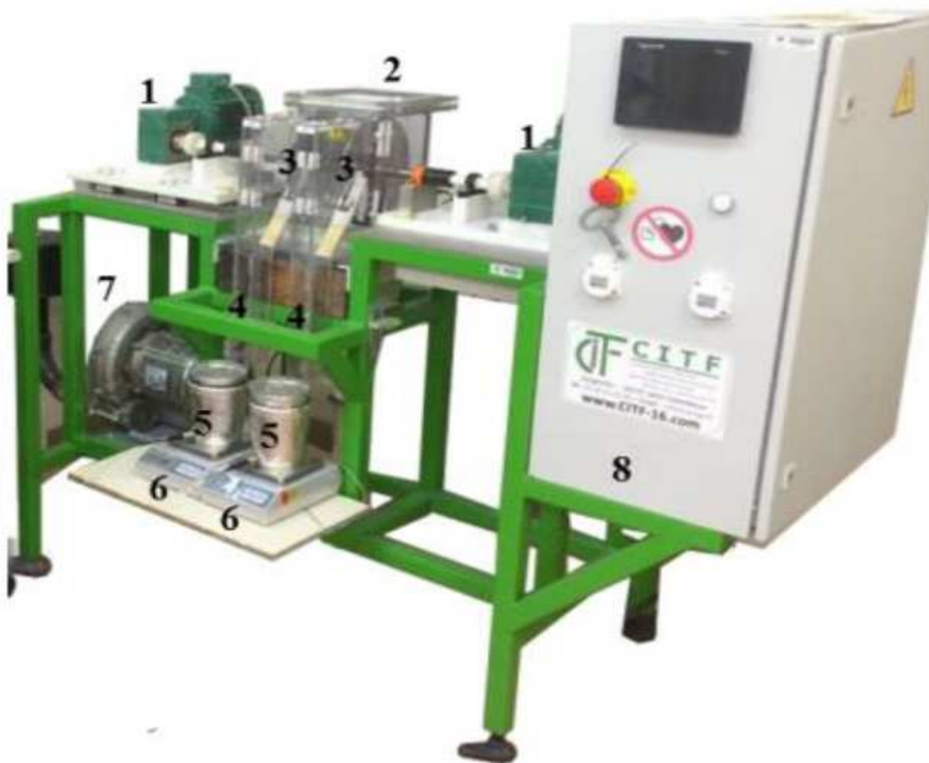
Figure 2.24. Photographie d'un séparateur tribo-aéro-électrostatique à disques
