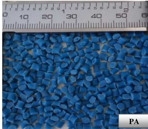
Figure 3.9. Echantillon des granules de polyamide (PA) utilisées.
