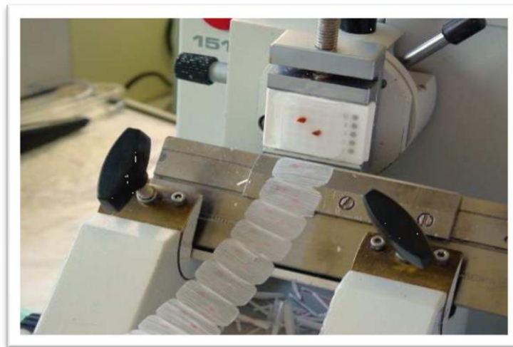
Figure n° 46: Obtention de ruban de coupe (Photo prise au service d'Anatomie pathologique, CHU de Sidi Bel Abbés).
