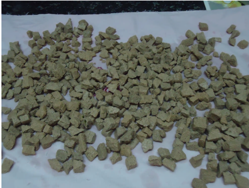
Figure II.5 : Pré-mouillage des agrégats légers ( la pierre ponce)
