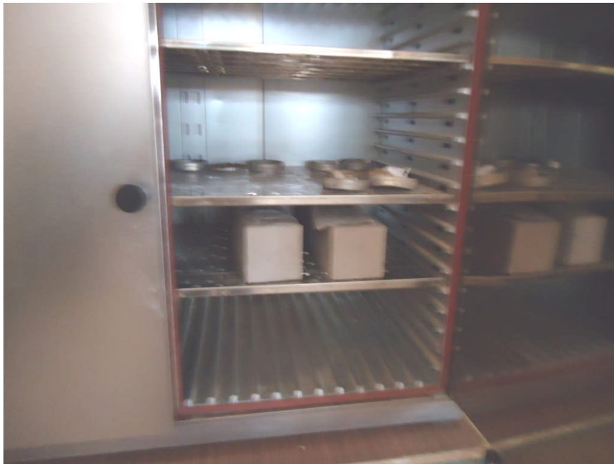
Figure III.3 : Séchage des éprouvettes en béton léger
