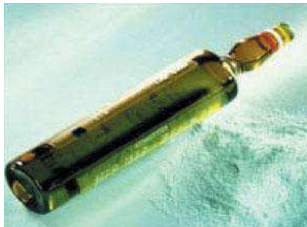
Figure II.4. Composition du liquide : Monomère (méthyl méthacrylate, butyl méthacrylate). Activateur (DmpT : N, N-dimethyl-p-toluïdine)
