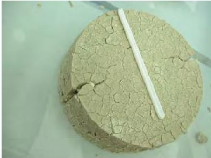
Figure I.4 : Fissurations importantes d'un échantillon de béton soumis au test de résistance aux sulfates (le bâtonnet blanc indique la longueur initiale de l'échantillon) [24]
