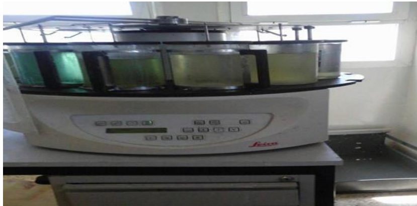
Photo 3 : Histokinette, Automate permettant l'inclusion des échantillons fixés dans de la paraffine après déshydratation
