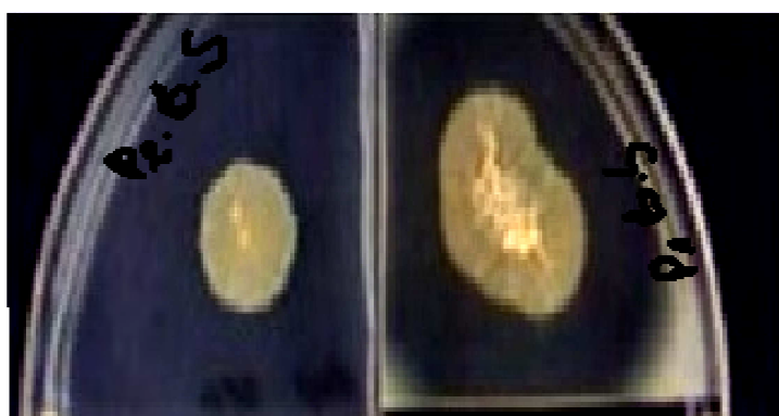
Photos 74. L'envahissement observé montre un début de la dégradation du polymère PEA1 et PEA2.
