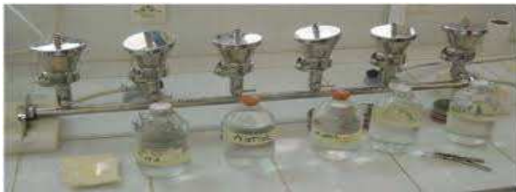
Figure 30. Pompe à filtration 06 postes
