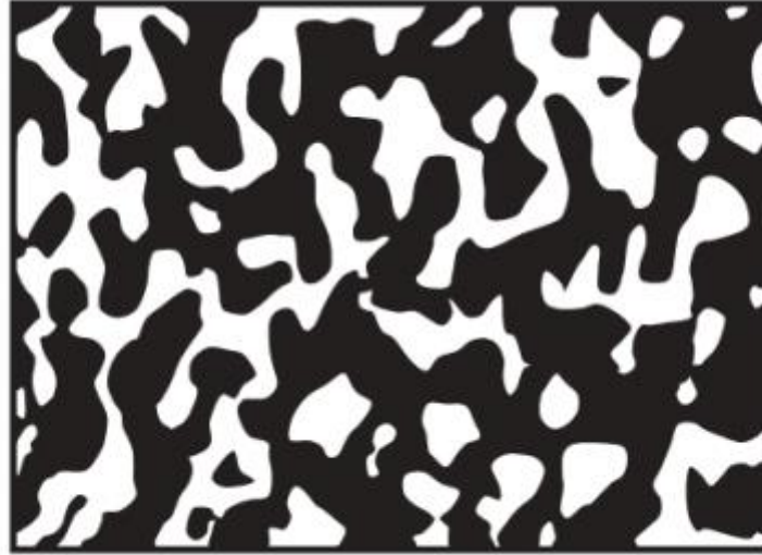
Figure II.12 : Matériau FGM à deux phases avec microstructure squelettique (Hill, 1995).
