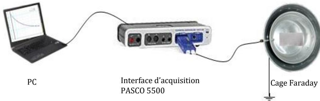
Figure III.7 : Schéma du poste de mesure du déclin de charge
