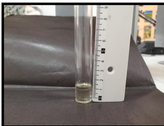
Figure 24: résultats final de l'huile essentielle du clou de girofle extrait par la méthode d'hydro distillation
