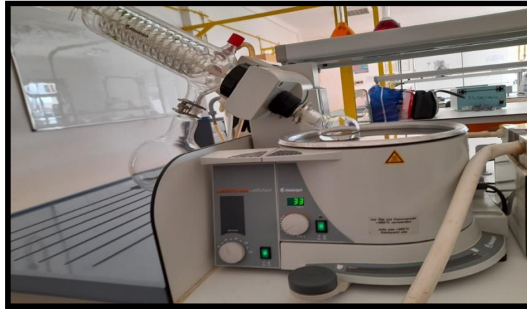
Figure 11: Séparation du solvant avec le rota vapeur
