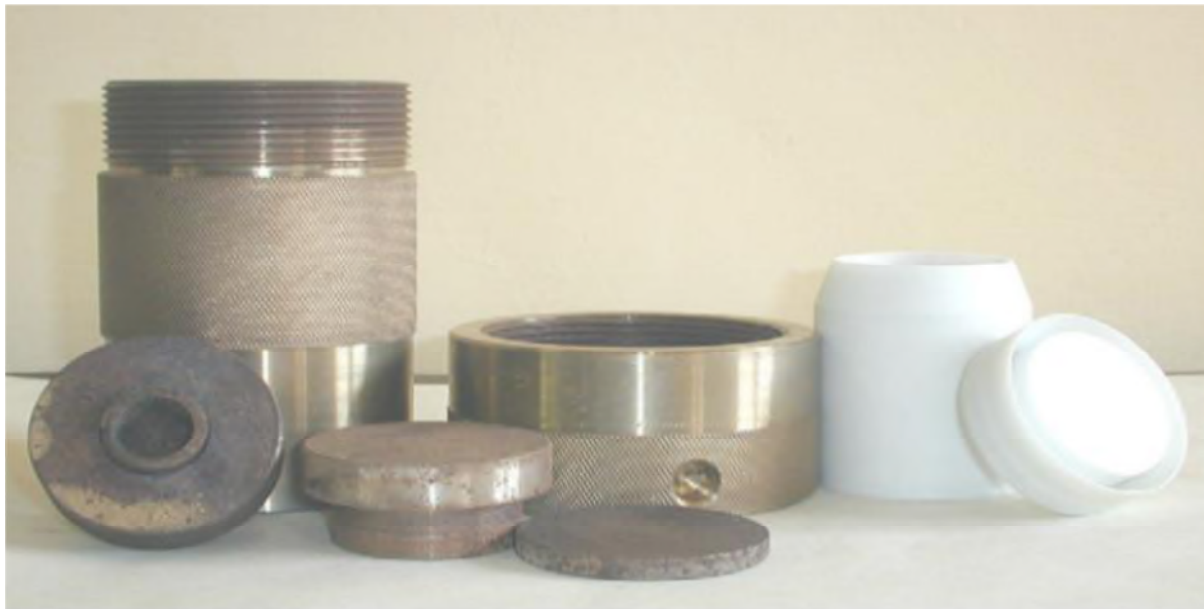
Figure III-2 : Autoclave populaire utilisé pour le traitement hydrothermique [184].
