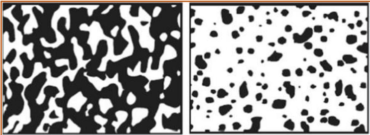
**Fig. II.3** : Deux phases matérielles avec (a) microstructure squelettique, et (b) microstructure particulaire (S.Vel et al 2002).
