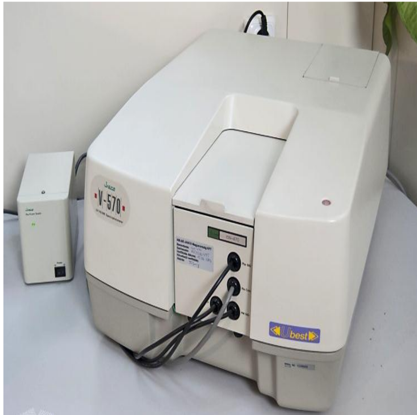
Fig. III.13 : Spectrophotomètre modèle JASCO 570 type UV-VIS-NIR.
