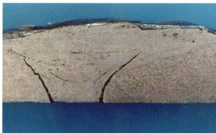
Figure I.12 : Fissure à froid détectée en macrographie.
