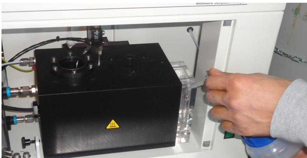
Figure II.15 : Photographie de microbalance de l'IGA-sorp.
