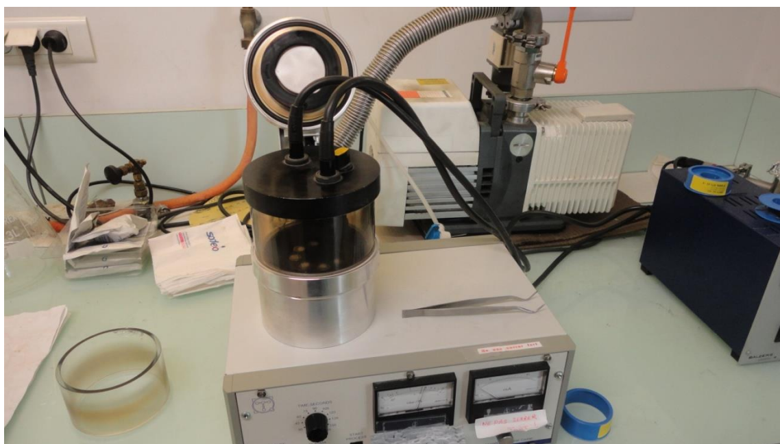
Figure II.13: Photographie de l'étape de carbonisation des argiles.
