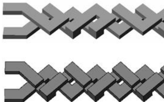
Figure I.27. Géométries des micromélangeurs à deux couches de canaux croisés (Xia, et al., 2005).
