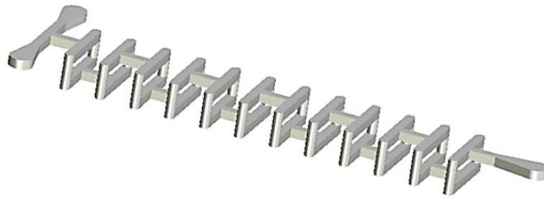
Figure I.22. Géométrie du micromélangeur avec motifs en forme de "H" (Victorov, et al., 2016).
