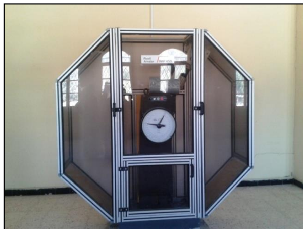
Figure 50: RKP 450 - Moutons pendule jusqu'à 450 joules
