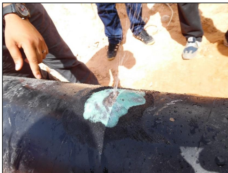
Figure 4 :Tube en API X42 qui cède pendant les essais hydraulique à 82 bar
