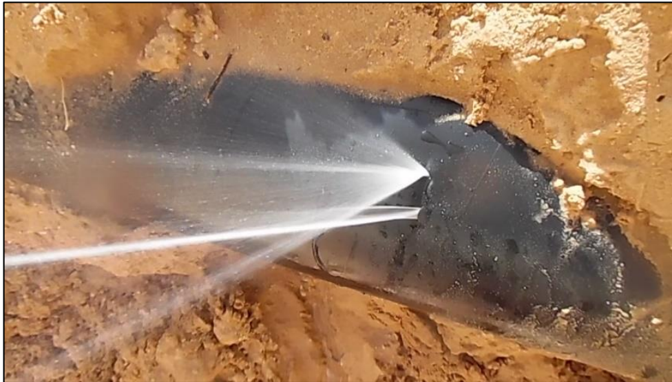
Figure 4 :Tube en API X42 qui cède pendant les essais hydraulique à 82 bar
