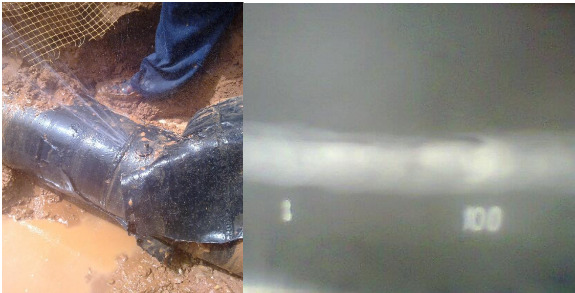
Figure 6 :Photo d'une fissure dans un joint de soudure a 32 bar.
