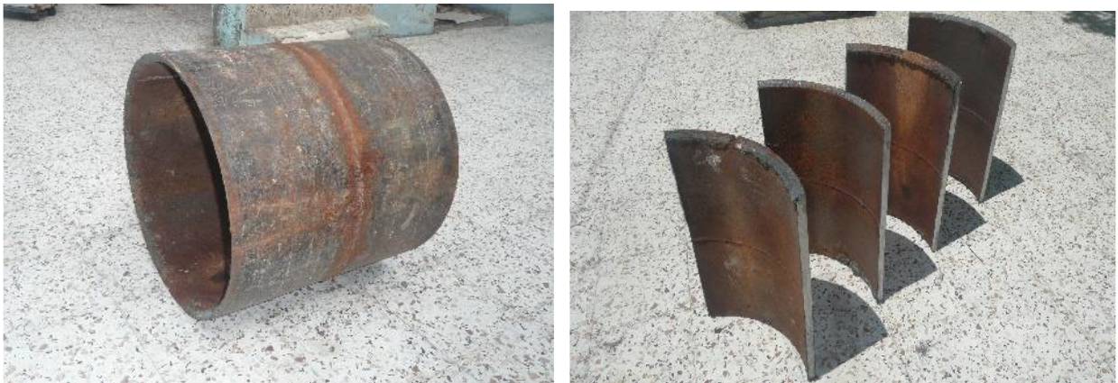
Figure 38: Photo de tube utilisé (a) tube soudé (b) tube découpé pour préparer à l'extraction des éprouvettes
