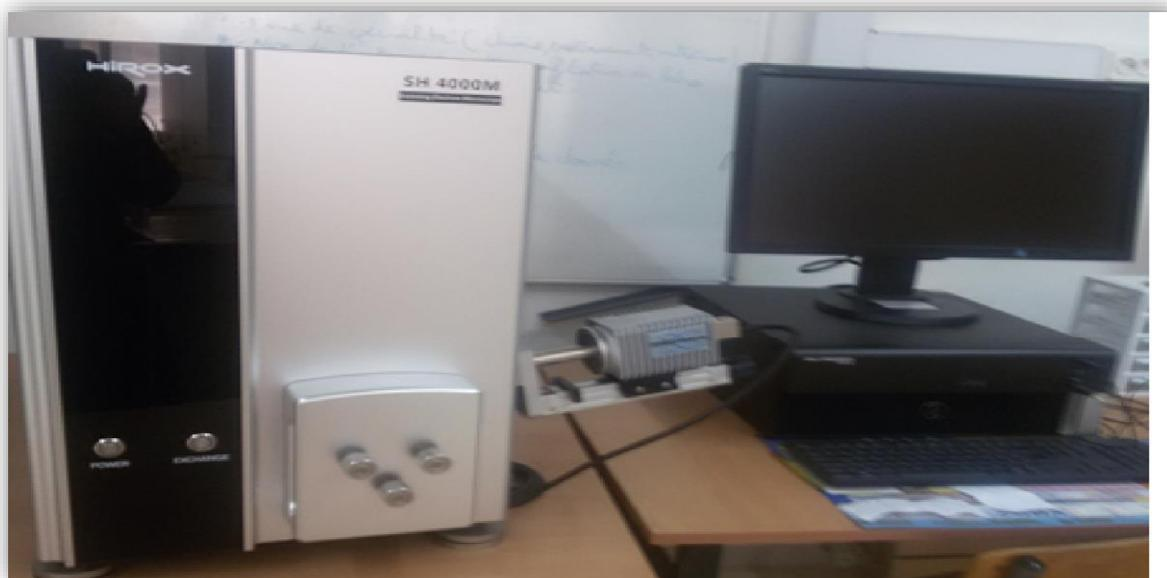
**Figure.II.5.** Appareillage de MEB-EDS (IROX SH 4000M)
