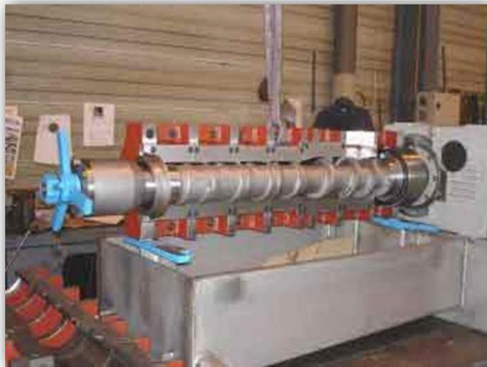
Figure .I.21. Appareillage de pressage à froid
