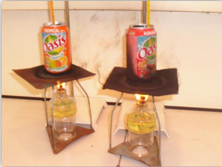
**Figure V.5.** Comparaison énergétique entre le diesel fossile et le biodiesel
