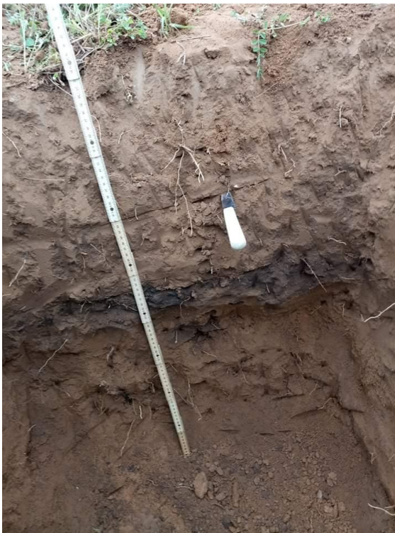
Figure 06 : L'utilisation du couteau pour distinguer entre les horizons (Profil 1 : Sidi Lahcen) (Cliché Bentkhici M., 2020)
