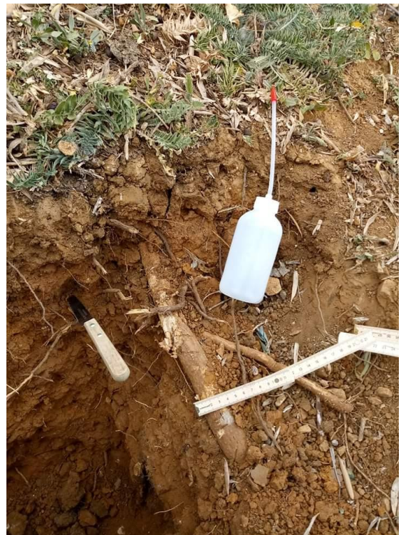
Figure 07 : L'appréciation du Calcaire à l'aide de l' HCl (Profil 2 : Mont Tessala) (Cliché Bentkhici M., 2020)
