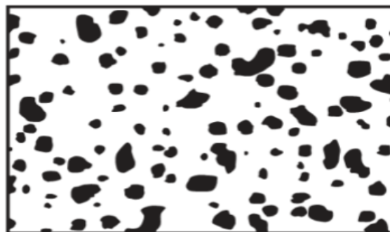
Figure II.15 : Matériau FGM à deux phases avec microstructure particulaire [35]
