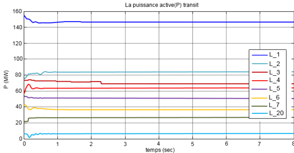
Figure III.40 : Le Flux de puissance active des lignes où nous avons enregistré une amélioration importante, du réseau IEEE-14 nœuds avec compensation (UPFC).
