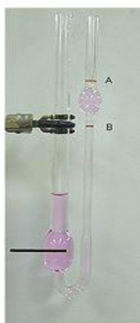
Figure 35 : Schéma d'un capillaire pour viscosimètre type KPG Cannon - Fenske.
