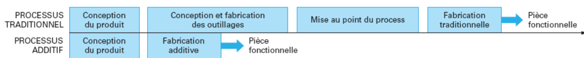
Figure I.11: Impact du processus choisi sur les temps et étapes de développement et fabrication d'une pièce fonctionnelle [27].
